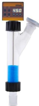
Дозаторы порошка используются **для безопасного, контролируемого и воспроизводимого дозирования** или подачи кристаллических или порошкообразных веществ **(в лабораторном масштабе)**
